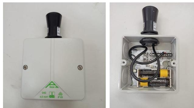
Abbildung 9: Gehäuse des Ultraschallsensors, links: geschlossen, rechts: geöffnet
